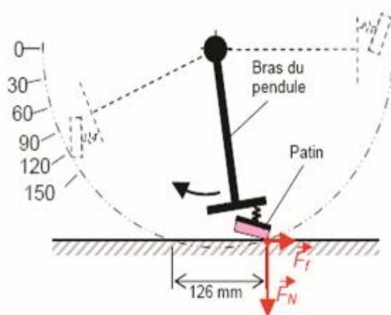
Le dispositif d'essai au pendule de frottement mesure la perte d'énergie lorsque le système de patin recouvert de caoutchouc normalisé glisse sur la surface d'essai.
