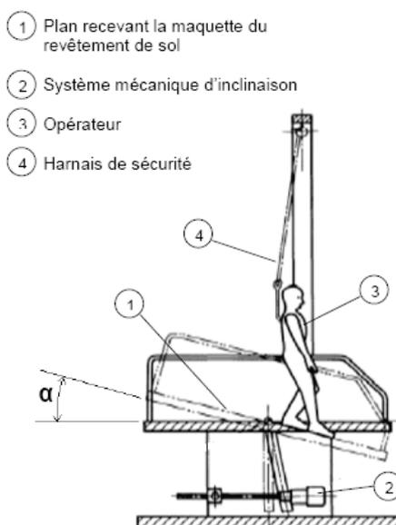
Le principe de la méthode du plan incliné repose sur un opérateur humain qui marche d'avant en arrière sur l'échantillon de revêtement de sol, ce dernier étant incliné d'un angle  $\alpha$  croissant par rapport à l'horizontale, jusqu'à obtention d'un début de glissade.
