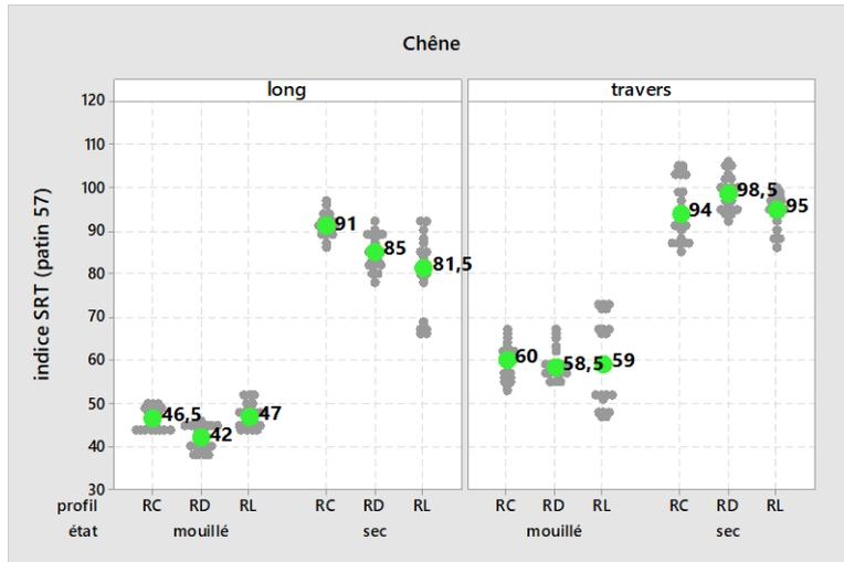
Le graphique suivant présente les résultats d'essais sur lames Ipé Lisse, profil RC, profil RD, sec et mouillé en sens long puis en sens travers.
